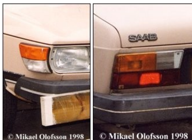
Körriktningvisarna plus parkeringsljusen, och bakljusen blev större 1977 (Nyare årsmodell på bilderna.)
